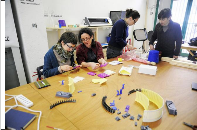
Assemblage d'une machine à tricoter contrôlée par ordinateur, construite avec une imprimante 3D et une machine à découpe laser (Fablab Wemake, Milan). / ©Dino FRACCHIA/REA
